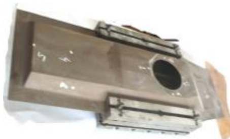
Рис. 1. Макет верхней части бронекорпуса БТР-80 с отмеченными характерными точками для фиксации ускорений, скоростей и перемещений
