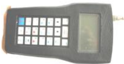
Рис. 2. Измерительная аппаратура для фиксации ускорений, скоростей и перемещений
