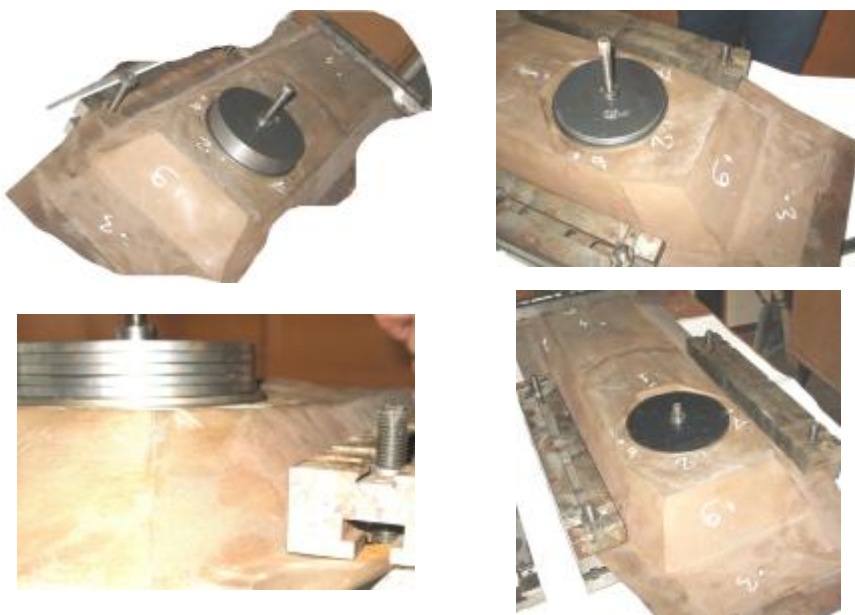
Рис. 3. Размещение на подбашенном листе модели корпуса БТР-80 различного количества стальных дисков, имитирующих изменение массы боевого модуля
