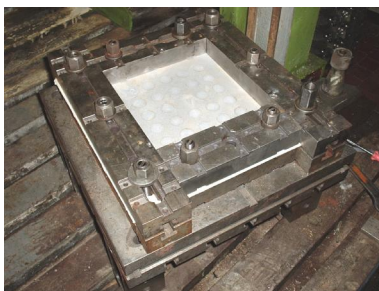
Рис. 4. Стенд „КРАБ” для испытательных сварных образцов
