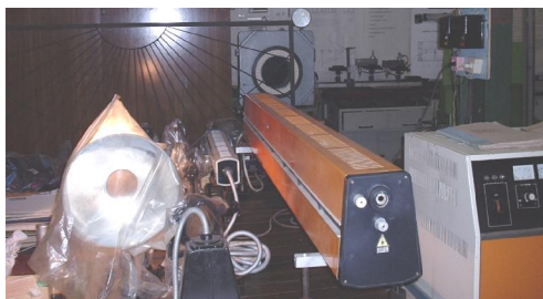
Рис. 3. Голографическая установка СИН-1, укомплектованная гелий-неоновым лазером ЛГН-215
