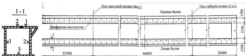
Рис. 32. Схема расположения отсеков по мостовым балкам и мест контроля толщин металла
