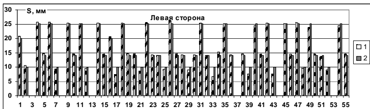
Рис.18. Толщины листов: 1 – измеренные, 2 – согласно чертежам
