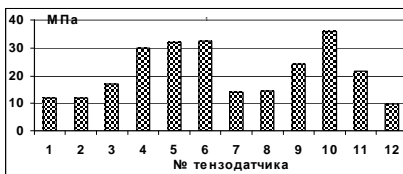
Рис. 6. Напряжения в тензодатчиках (см. схема расположения на рис. 1) под действием динамической пробной нагрузки Р = 1,1 ном. (325 кН)
