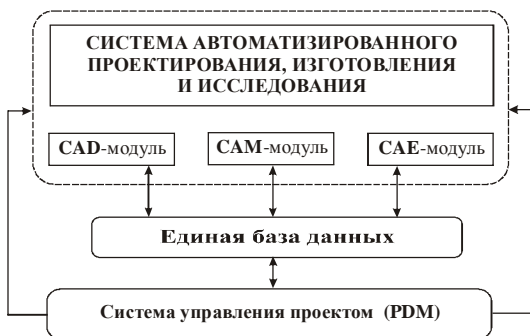
Рис. 3. Схема обмена информацией в единой интегрированной CAD/CAM/CAE/PDM-системе
