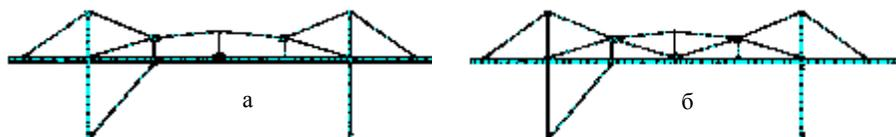
Рис. 9. Различие шпренгельных систем: а – прототип; б – исследуемая модель
