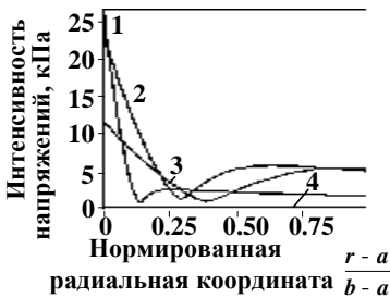
Рис. 7. Распределение интенсивности напряжений в сосуде с \epsilon_{\max} = -0.1 для различных моментов времени: 1 – 0.001t_* , 2 – 0.01t_* , 3 – 0.1t_* , 4 – t_*
