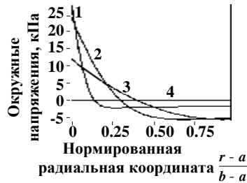
Рис. 5. Распределение окружных напряжений в сосуде с \epsilon_{\max} = -0.1 для различных моментов времени: 1 – 0.001t_* , 2 – 0.01t_* , 3 – 0.1t_* , 4 – t_*
