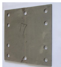
Пластина, сваренная из 2-х равных прямоугольников
