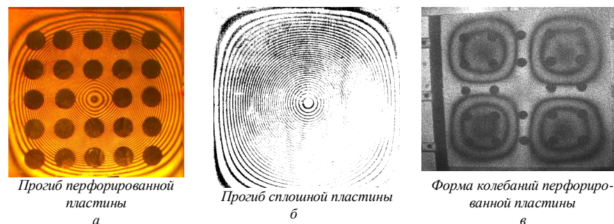
Рис. 7. Примеры интерферограмм (сплошные и перфорированные пластины)
