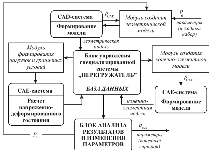
Рис. 1. Схема работы специализированной системы анализа напряженно-деформированного состояния и синтеза параметров мостового перегружателя
