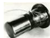
Рис. 3. Исследуемое металлополимерное гибкое колесо СВЗП
