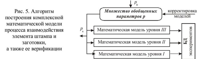
Рис. 5. Алгоритм построения комплексной математической модели процесса взаимодействия элемента штампа и заготовки, а также ее верификации
