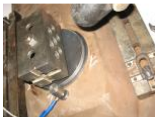
Рис.4. Возбуждение ударной нагрузки на макет в поперечном направлении
