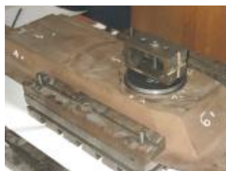
Рис.1. Закрепление макета и размещение имитатора боевого модуля
