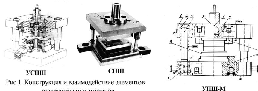
Рис.1. Конструкция и взаимодействие элементов разделительных штампов
