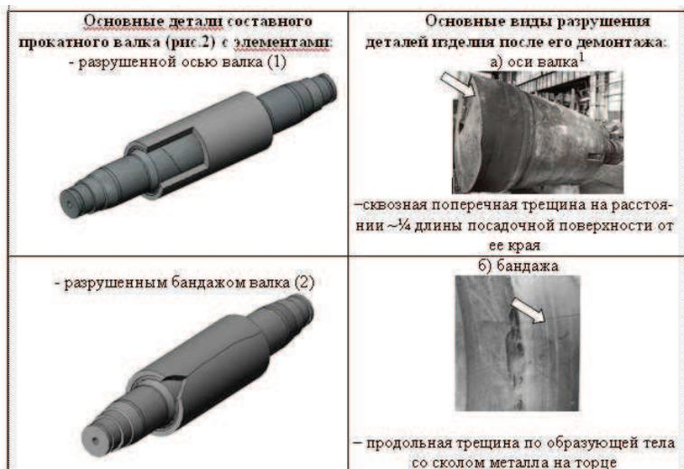
Рис. 1. Охватываемая и охватывающая детали составного изделия и основные виды их разрушения: оси валка (а) и банджа (б)
