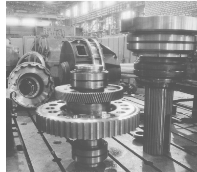
Рис. 4. Производство передач с промежуточными телами качения для механических приводов рудоразмольного оборудования
