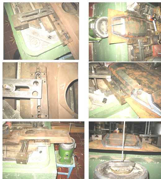
Рис. 3. Крепление моделей и возбуждение собственных форм колебаний на вибростенде
