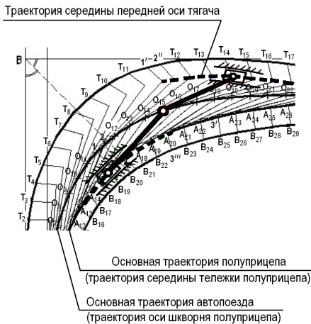
Рис. 6 – Схематичное представление движения автопоезда на повороте
