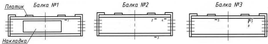
Рис. 3 – Схема установки тензорезисторов на подрешетных балках
