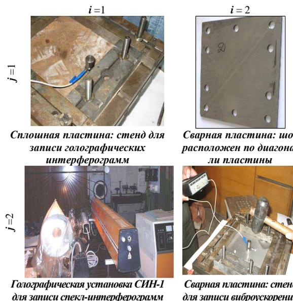
Рис. 3 – Стенды и аппаратура для экспериментальных исследований фрагмента бронекорпуса
