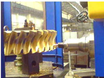
Рис.6 – Нарезка зубьев на червячном колесе выполняется на универсальном многокоординатном обрабатывающем центре TOS Varnsdorf
