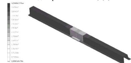
Рис. 31 – Эквивалентные напряжения по Мизесу (P)
