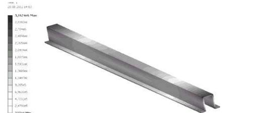
Рис. 35 – Эквивалентные напряжения по Мизесу (И, P1)
