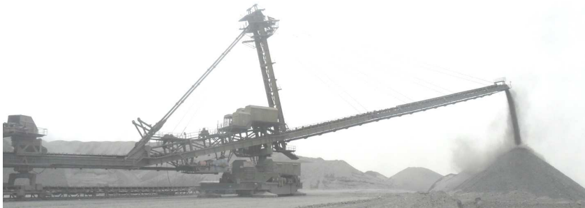
Рис. 5 – Отвалообразователь ОШС-4000/125 – карьер „Мурунтау”
