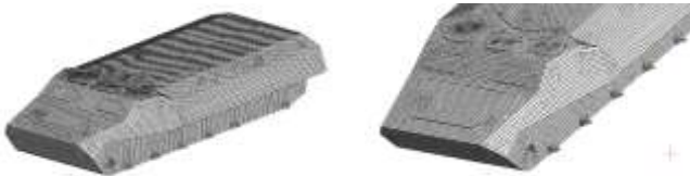
Рисунок 3 – Конечно-элементная модель (~33 000 КЭ)
