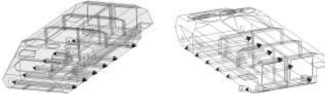
Рисунок 4 – Моделирование граничных условий опирания
