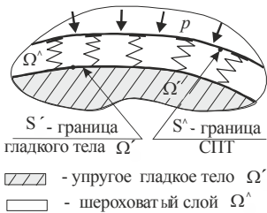
Рисунок 6 – Модель шероховатого сложнопрофильного упругого тела
