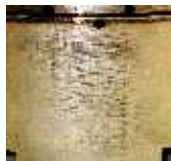
Рисунк 8 – Бокова поверхня поршня СМД після випробувань і після корундування
