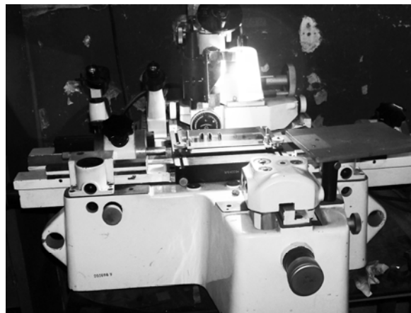
Рисунок 2 - Замеры образцов на инструментальном микроскопе БМИ
