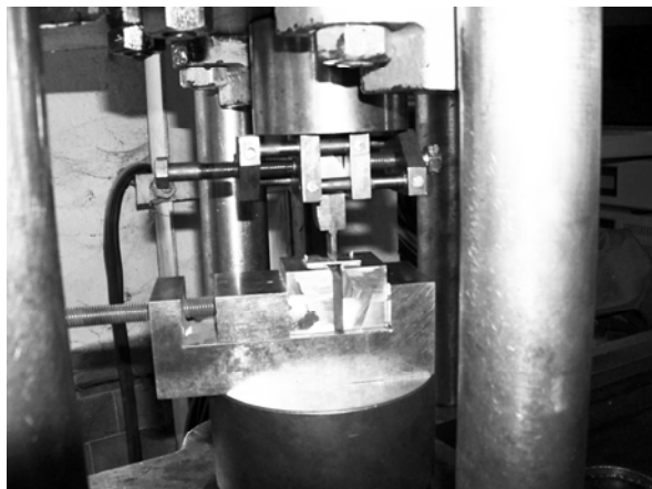
Рисунок 1 – Изгиб образцов по ГОСТ 14019 на УИМ 50М
