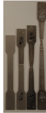
Рис. 2. Исходный и продеформированные образцы AZ31
