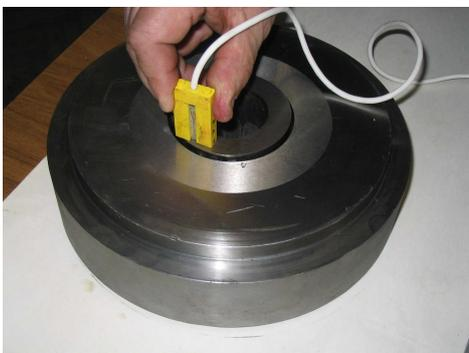
б) Рис.1. Лицевая панель виртуального дефектоскопа на экране монитора (а) и контроль матрицы плоским датчиком (б)
