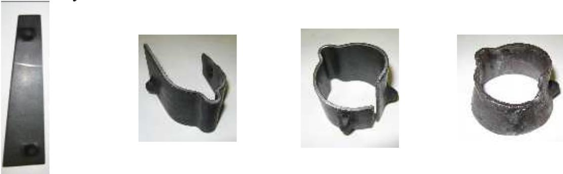
Рис.5. Технологический процесс изготовления верхней чашки
