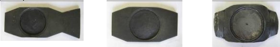
Рис.4. Техпроцесс изготовления клина
