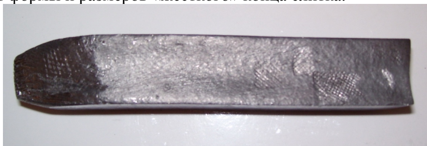
Рис. 4 Форма торца раската после прокатки слитка с «жестким» концом в лабораторных условиях.
