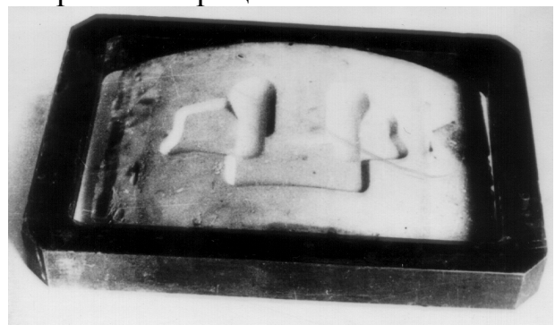
Рис. 2. Примеры сменных матриц с формообразующим элементом из пластмассы АСТ-Т
