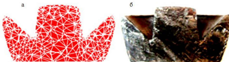
Рис. 3 - Сравнение геометрии полученных образцов после 1-й стадии а - вид образца, полученный математическим моделированием; б - экспериментально полученный образец.
