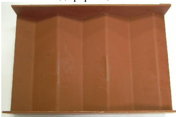
Рис. 5. Металоконструкція, яка виготовлена з використанням гофрованої полоси
