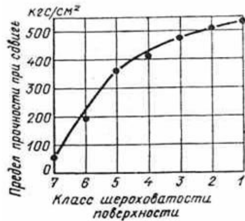
Рис.2. Зависимость прочности клеевого соединения от величины шероховатости соединяемых поверхностей
