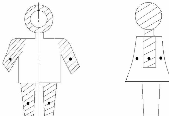
Принцип работы экранирующей одежды состоит в следующем. Для того, чтобы достиглось ослабление электромагнитного излучения произвольной поляризации, токопроводящая нить в ткани устанавливается таким образом, чтобы образовалась металлическая сетка. Для изготовления экранирующей одежды используют экранирующую ткань.
