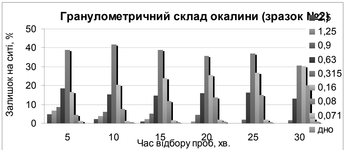
Рис. 3. Гранулометричний склад окалини другого зразка в результаті подрібнення в кульовому млині протягом 30 хвилин
