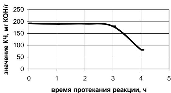
Рис. 1 - Изменение кислотного числа во время протекания реакции этерификации молочной кислоты этиловым спиртом
