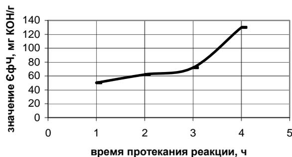
Рис. 2 - Изменение эфирного числа во время протекания реакции этерификации молочной кислоты этиловым спиртом
