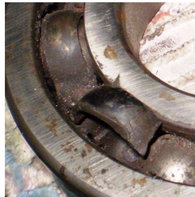
Рис. 2 Цвета побежалости на сепараторе разрушенного подшипника
