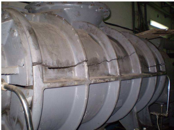
Рис.1 Разрушение корпуса насоса
