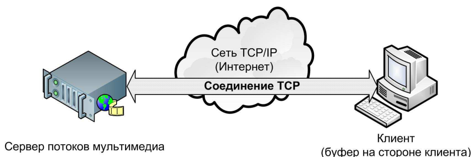
Рис. 1 Клиент-серверная архитектура соединения TCP при потоковой передаче данных (сервер передает потоковое видео клиенту посредством протокола TCP, на стороне клиента сегменты, прибывающие ранее времени проигрывания, запоминаются в буфере)
