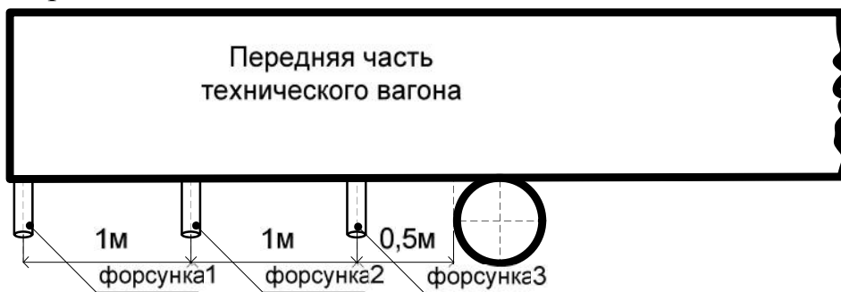
Рис.2. Схема установки плазменных форсунок на техническом вагоне.
