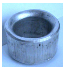
Рис. 4. Дефект утяжина, полученный на верхнем (а) и нижнем (б) торцах втулки
