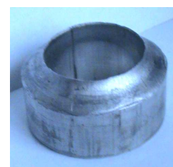
Рис. 4. Дефект утяжина, полученный на верхнем (а) и нижнем (б) торцах втулки
