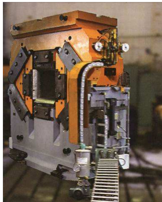
Рис. 4. Общий вид четырехбойкового устройства для ковочного пресса силой 20 МН
