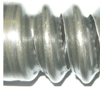
Рис. 21. Фотография трубы с винтовой трещиной
