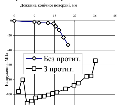
Рис. 7. Розподіл радіальних напружень
