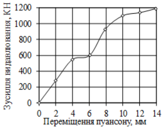
Рис.4. Залежність зусилля видавлювання від переміщення пуансону.
