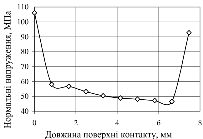
Рис. 10. Розподіл нормальних напружень на поверхні заготовки, яка контактує з пуансоном
