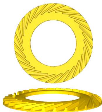
Рис. 5. Отштампованная заготовки детали «Диффузор радиальный»
