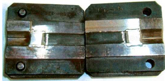
Рис. 2 Роз'ємні напівматриці для пресування заготовок робочих лопаток
