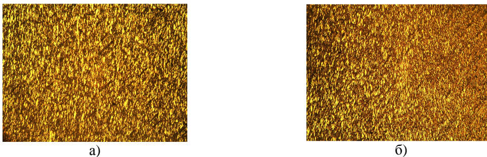
Рис. 8. Структура металу в напрямку вісі пера лопатки: а, б - різні ділянки повздож вісі пера лопатки
