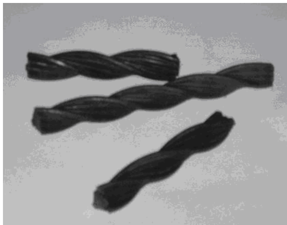
Рис. Внешний вид образца трехгранного арматурного каната длиной 70 мм (шаг свивки составляет 82 мм).
