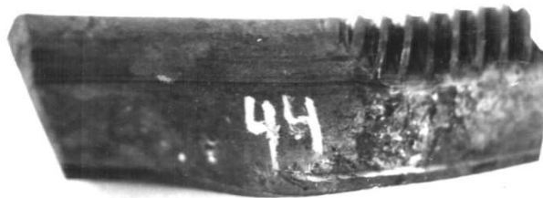
Рис. 5. Недокат, полученный при опробовании нового способа прокатки
