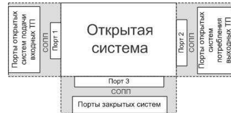
Рис. 3 Интерфейсная модель открытой управляемой системы: Порт 1 – порт, связанный с системами подачи входных ТП. Порт 2 – порт, связанный с системами потребления выходных ТП. Порт 3 – порт, связанный с обеспечением функционирования закрытых систем
